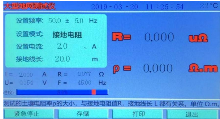
(图 15) 接地电阻测试界面
