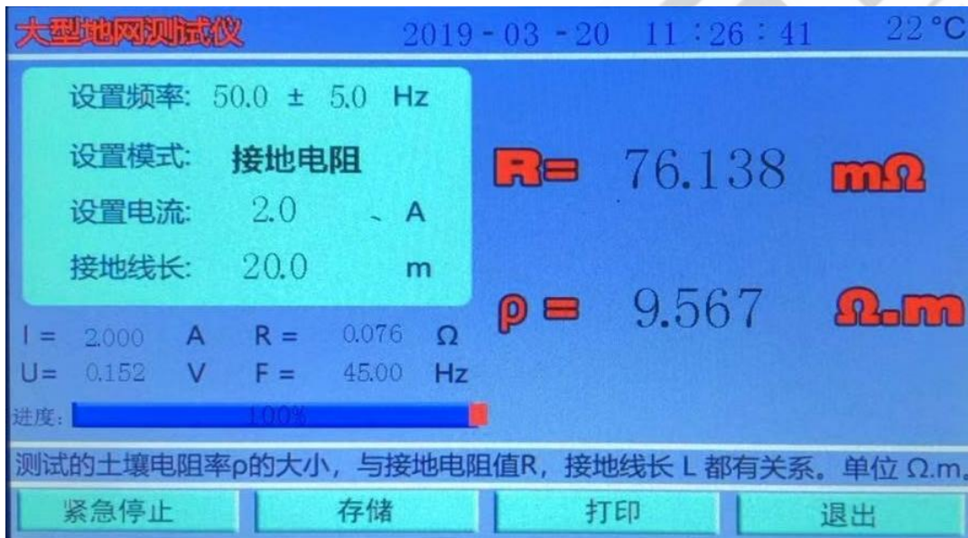
(图 16) 接地电阻测试结果界面
